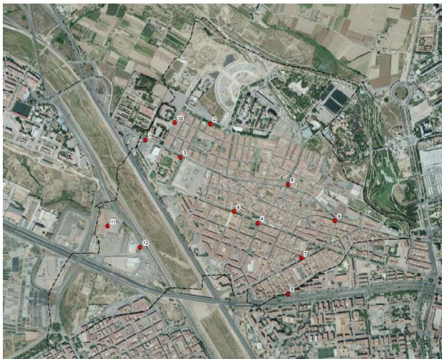
Por otro lado, se han realizado de mediciones de larga duración con un periodo mínimo de 24 horas, para ello se han instalado estaciones de medición de ruido en continuo. La ubicación de dichas mediciones se ha planificado teniendo en cuenta entre otros factores, las quejas y reclamaciones de los vecinos por las molestias que ocasionan ciertos emisores acústicos. Seguidamente se representa la distribución de los puntos de medida de larga duración:
